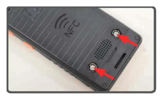
步骤 2: 利用电池盖下方的凹槽,取下电池盖
